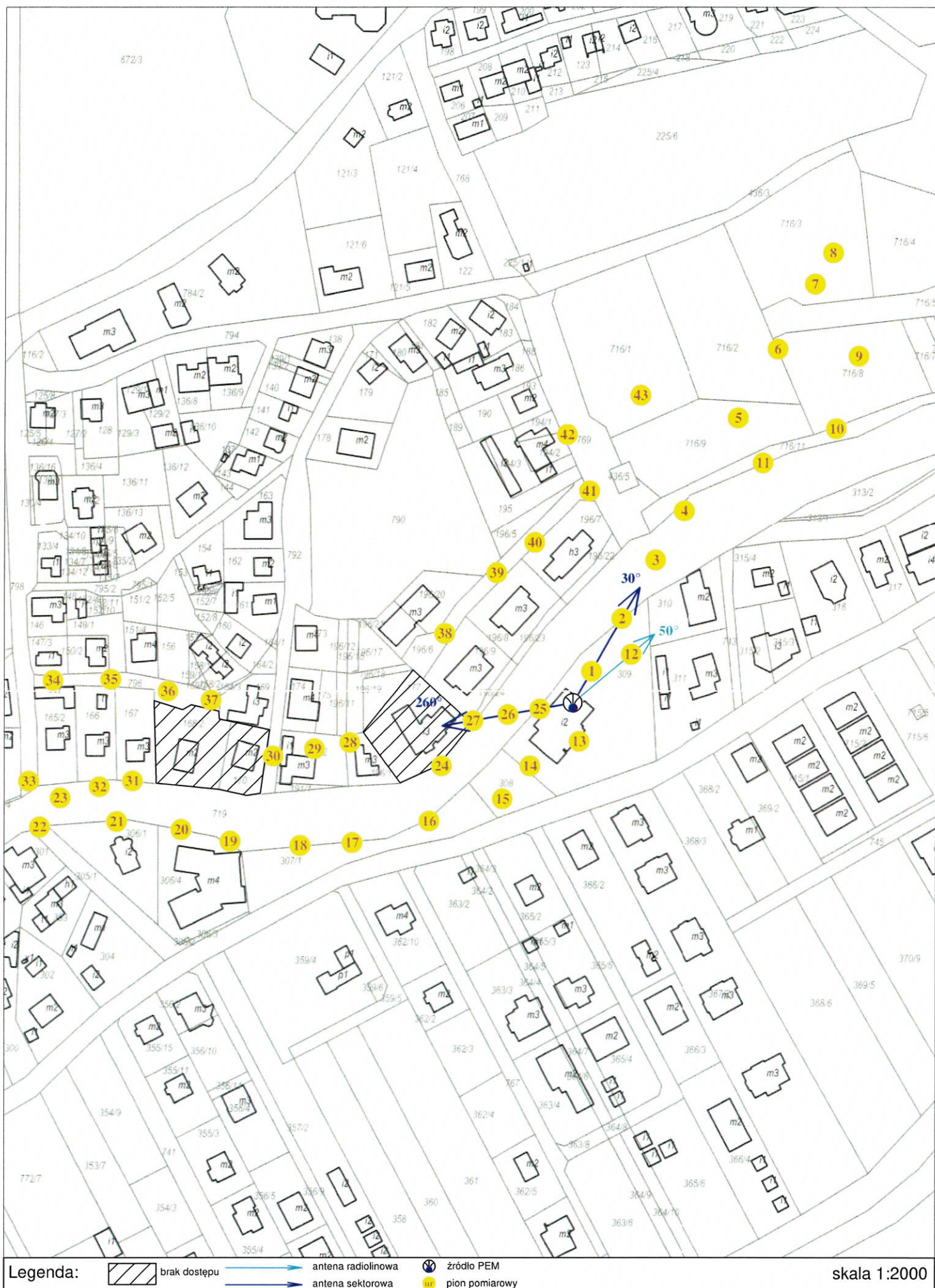
Rys. 2 Lokalizacja pionów pomiarowych
