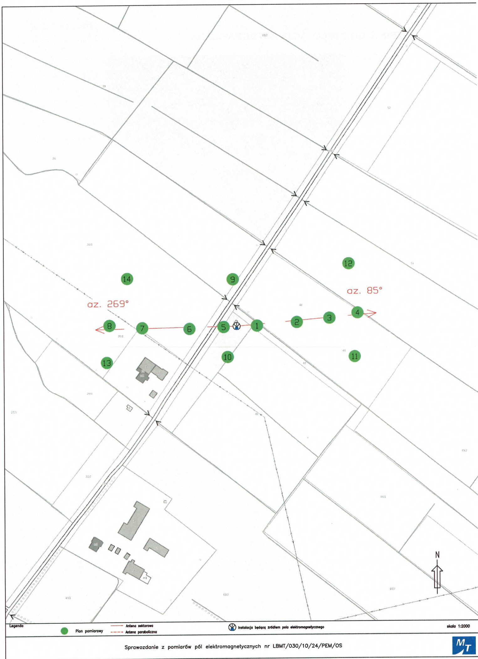
Rys.1 Lokalizacja pionów pomiarowych
